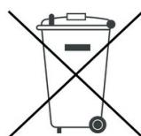
Kennzeichnungspflichtige Batterien sind mit dem Symbol einer durchgestrichenen Mülltonne und dem chemischen Symbol des für die Einstufung als schadstoffhaltig ausschlaggebenden Schwermetalls gekennzeichnet. Das chemische Symbol (Cd, Hg oder Pb) wird unter dem Mülltonnen-Symbol abgebildet.
